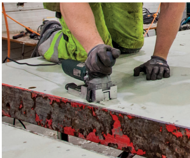
Dekket av RentalPlus: Overhaling og overflatebehandling av alkus-platen.
