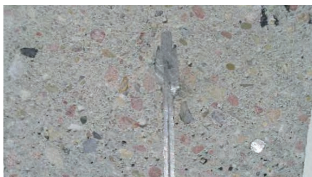
Overlappingsonen til CEMflex (kun 5cm er nødvendig) vil reagere og forsegles automatisk dersom vann trenger inn. Den aktive tetteprosessen er avsluttet innen få timer. Vann har deretter ingen mulighet for å trenge inn.
